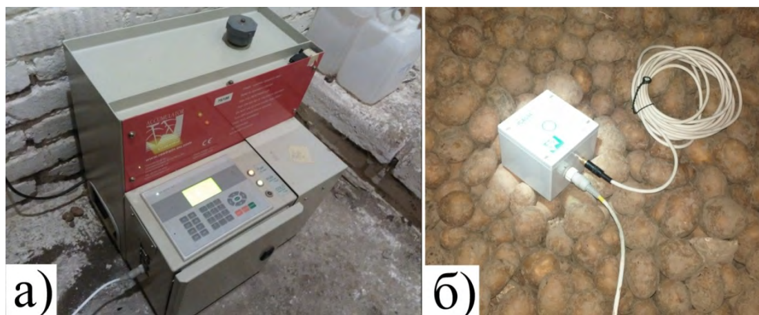
Рисунок 44. Оборудование фирмы «Restraining», использовавшееся в эксперименте: а) генератор этилена; б) датчик концентрации этилена, расположенный на поверхности насыпи картофеля в хранилище
